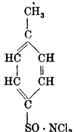
das er Dichloramine T nannte. Wie schon Chataway nachgewiesen hat, geht es in wässriger alkalischer Lösung leicht in das Monochlorsulfonamid
